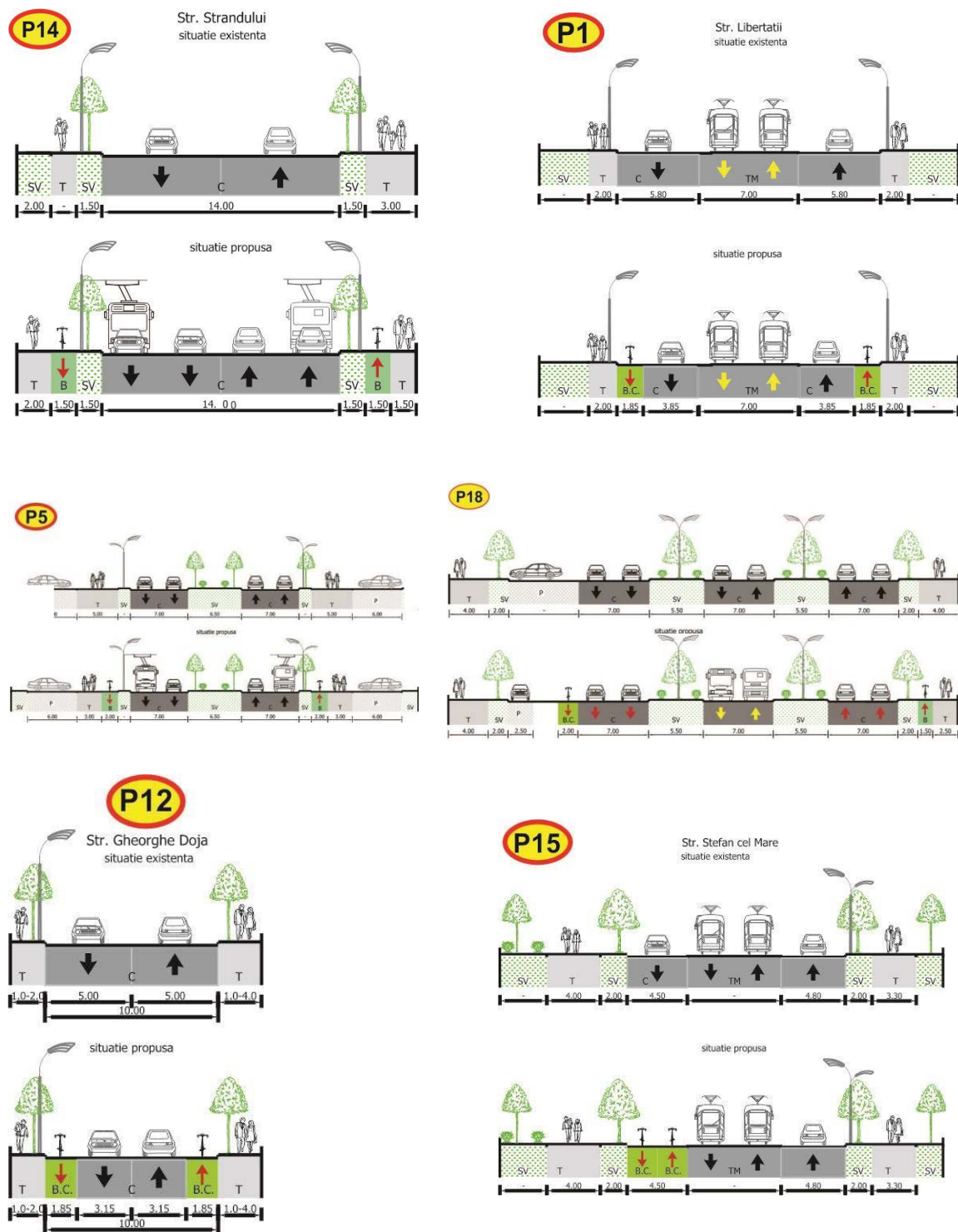
Figură 78 Propuneri de amenajare a infrastructurii pentru biciclete în etapa I. Profile transversale Sursă: P.M.U.D. Ploiești
